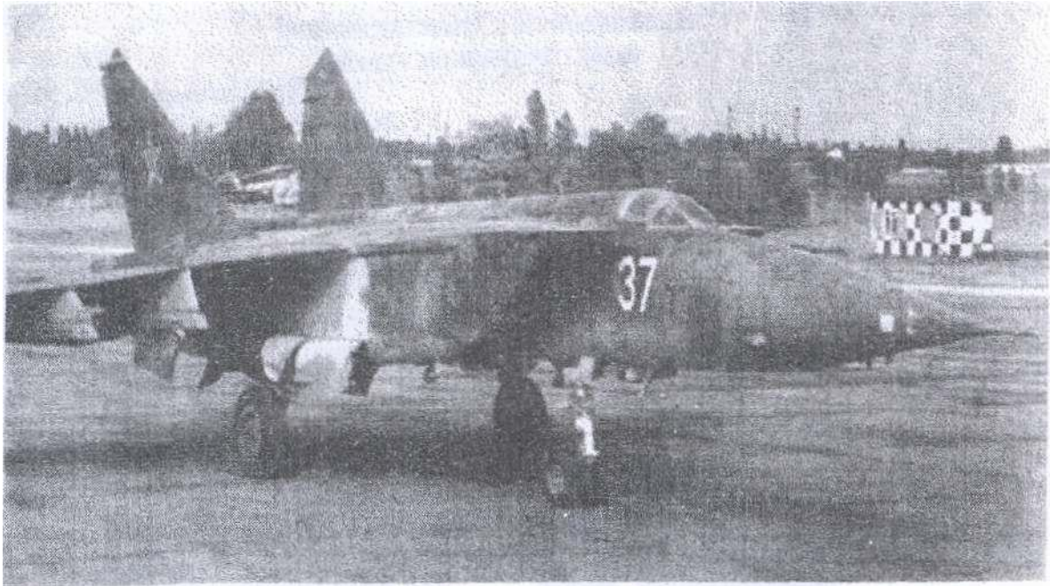
Ударный самолет МиГ-25БМ. На нем установлено крыло с отрицательным углом поперечного V.
