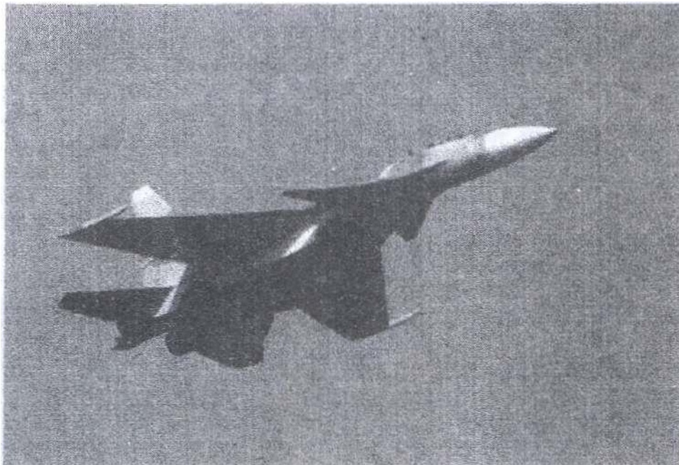
Су-37 выполнен по пока еще редкой аэродинамической схеме - «тандем»
