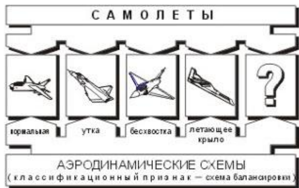
Рис. 7.19. Классификация самолетов по аэродинамическим схемам
